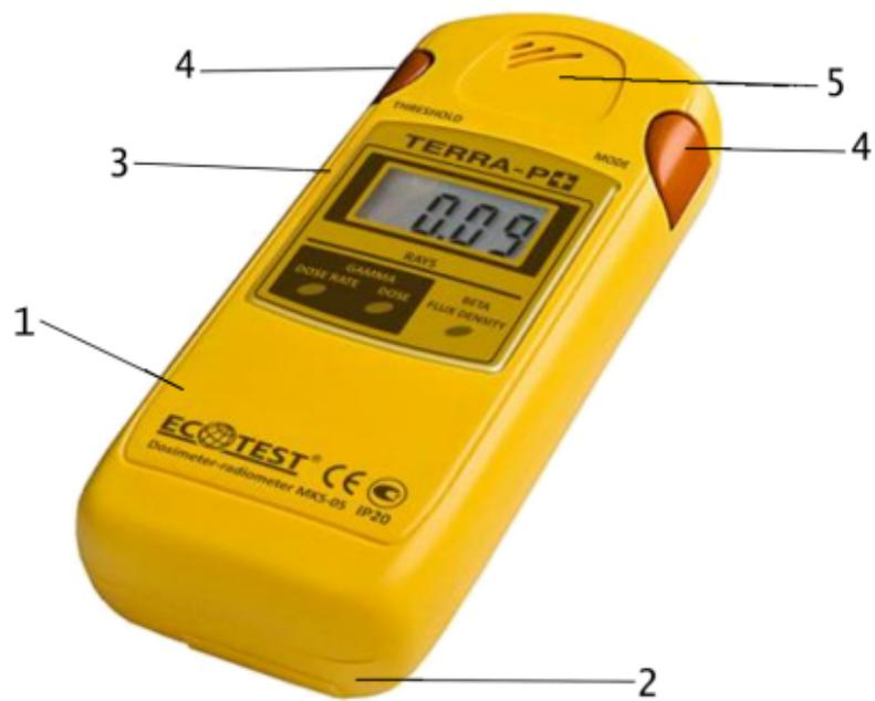
Рисунок 1 - Общий вид дозиметра
