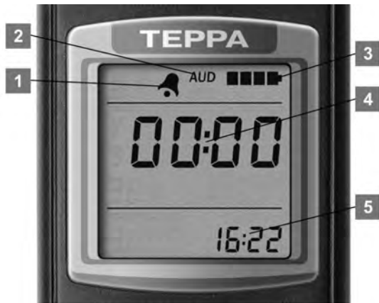
Рисунок 25 – ЖКИ дозиметра (режим будильника)
