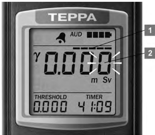
Рисунок 12 – ЖКИ дозиметра (подрежим программирования нового значения порогового уровня срабатывания сигнализации)
