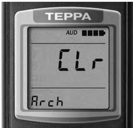
Рисунок 31 – ЖКИ дозиметра (подрежим стирания результатов измерений, сохраненных в энергонезависимой памяти)
