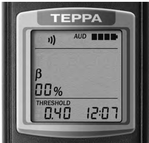
Рисунок 15 – ЖКИ дозиметра (просмотр значения заданной статистической погрешности)
