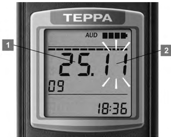
Рисунок 24 – ЖКИ дозиметра (подрежим коррекции времени и даты – программирование даты)
