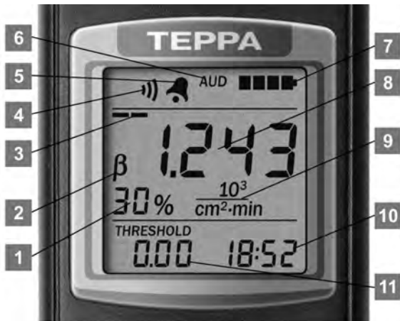
Рисунок 14 – ЖКИ дозиметра (режим измерения поверхностной плотности потока частиц бета-излучения)
