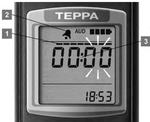
Рисунок 26 – ЖКИ дозиметра (подрежим программирования времени срабатывания будильника)
