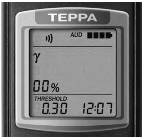
Рисунок 4 – ЖКИ дозиметра (просмотр значения заданной статистической погрешности)
