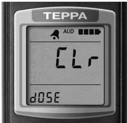
Рисунок 13 – ЖКИ дозиметра (подрезим обнуления значения ЭД и времени накопления ЭД)
