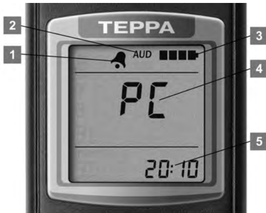
Рисунок 27 – ЖКИ дозиметра (режим управления информационным обменом с ПК)
