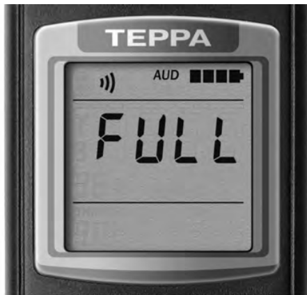
Рисунок 9 – ЖКИ дозиметра (начало подрежима сохранения результата измерения – в энергонезависимой памяти нет свободного места)
