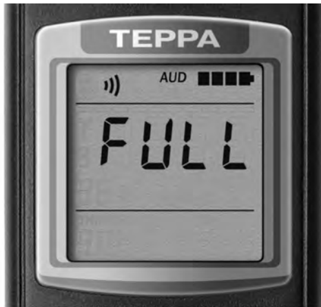
Рисунок 19 – ЖКИ дозиметра (начало подрежима сохранения результата измерения – в энергонезависимой памяти нет свободного места)
