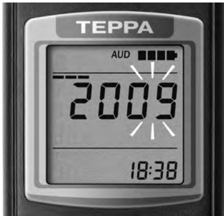
Рисунок 23 – ЖКИ дозиметра (подрежим коррекции времени и даты – программирование года)
