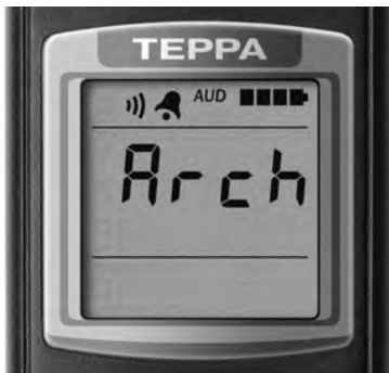
Рисунок 5 – ЖКИ дозиметра (начало подрежима сохранения результата измерения в энергонезависимой памяти)
