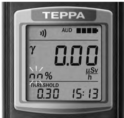
Рисунок 6 – ЖКИ дозиметра (перезапуск измерения)
