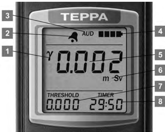
Рисунок 11 – ЖКИ дозиметра (режим отображения накопленного значения ЭД фотонного ионизирующего излучения)
