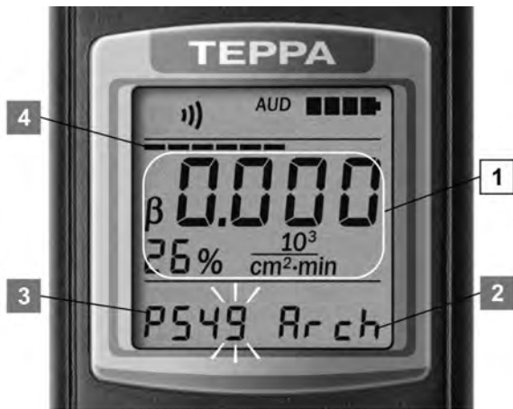
Рисунок 20 – ЖКИ дозиметра (подрежим сохранения результата измерения поверхностной плотности потока частиц бета-излучения)
