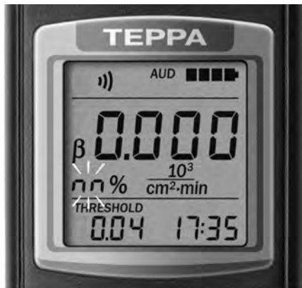
Рисунок 17 – ЖКИ дозиметра (перезапуск измерения)
