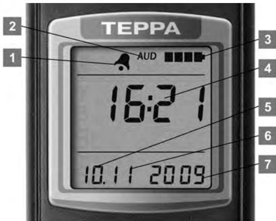
Рисунок 21 – ЖКИ дозиметра (режим часов)
